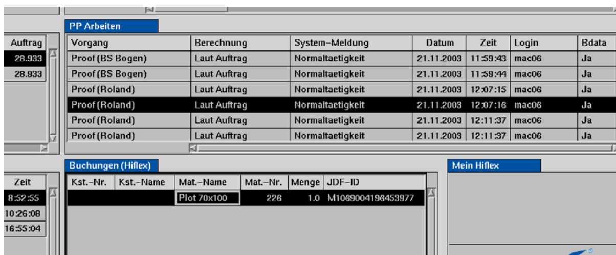
Bild 5c: Im „PP Arbeiten“-Fenster von Hiflex gibt es die Informationen über die Prinergy-Prozesse und ihre Zuordnung zu den Worktypes, in Buchungen erscheinen die Materialverbräuche.
